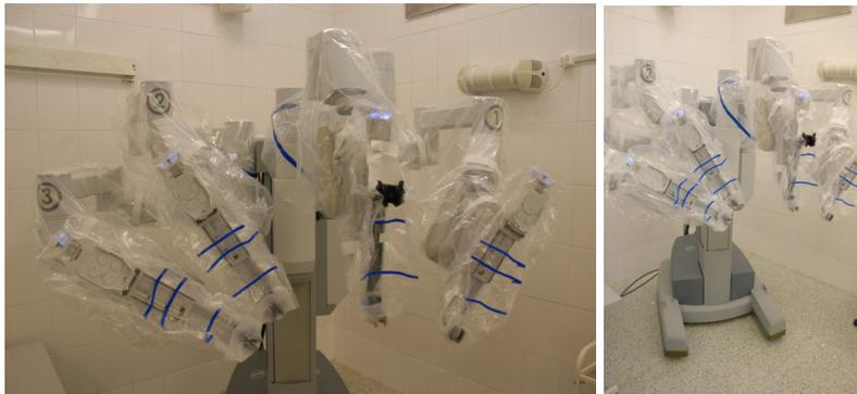
Рис. 13. Тележка пациента роботической системы da Vinci с расположенными на ней рабочими манипуляторами
